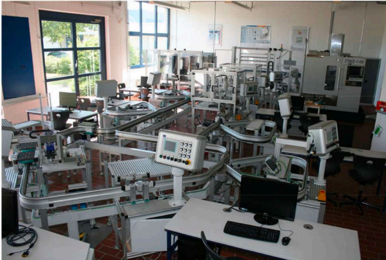
Flexible, materialflussorientierte Fertigungsstrecke (FFS)
